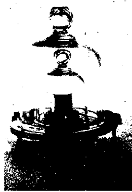
figura 1-2 Este é o quilograma padrão n.º 20 sob a guarda do "National Bureau of Standards" nos EUA. É uma reprodução fiel do padrão internacional que se acha preservado no Bureau Internacional de Pesos e Medidas, próximo de Paris. O quilograma padrão é o cilindro de platina no interior da campânula menor.
