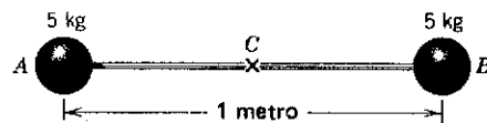
figura 12-6 Exemplo 2. Cálculo da inércia rotacional ou momento de inércia, de um haltere.
