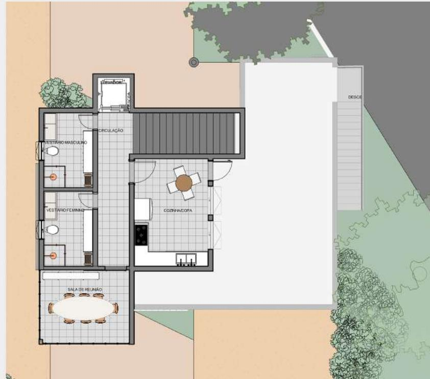
Figura 44: Planta baixa bloco 01
