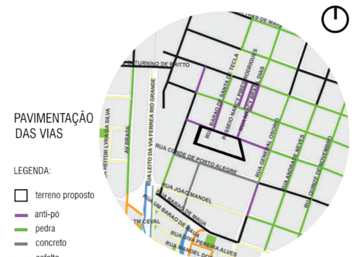
figura 32 - condições da pavimentação do entorno fonte: GeoPelotas
