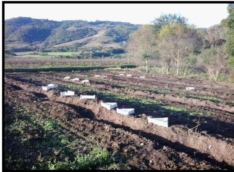
Figura 6 - Pomar de pêssigo onde foram instalados os coletores de erosão. Vista da parte mais alta, onde está o tratamento com 8t ha<sup>-1</sup> de palha de aveia, para a parte mais baixa da área, onde está o tratamento com 0t ha<sup>-1</sup>.
