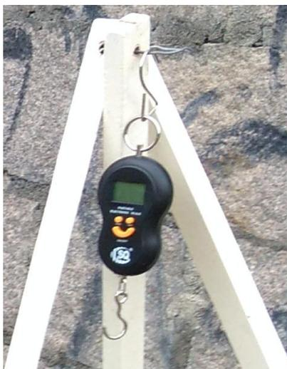
Figura 1 – Imagem da balança portátil com gancho, utilizada para quantificação dos resíduos.
