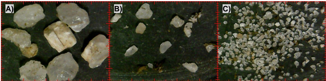
Figura 28 - Registro fotográfico evidenciando a granulometria das areias referentes ao Perfil 2 - Horizonte 1, ampliadas com o auxílio do microscópio. Figura (A) registra a granulometria areia muito grossa; a Figura (B) registra a granulometria areia grossa e a Figura (C) registra a granulometria areia média. Imagens obtidas em microscópio digital modelo U1000X. Escala de 0,2 mm.
