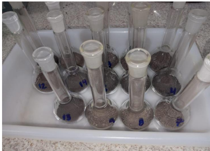
Figura 11 - Registro fotográfico do solo no balão volumétrico para determinação da densidade de partículas. Fonte: Autora.
