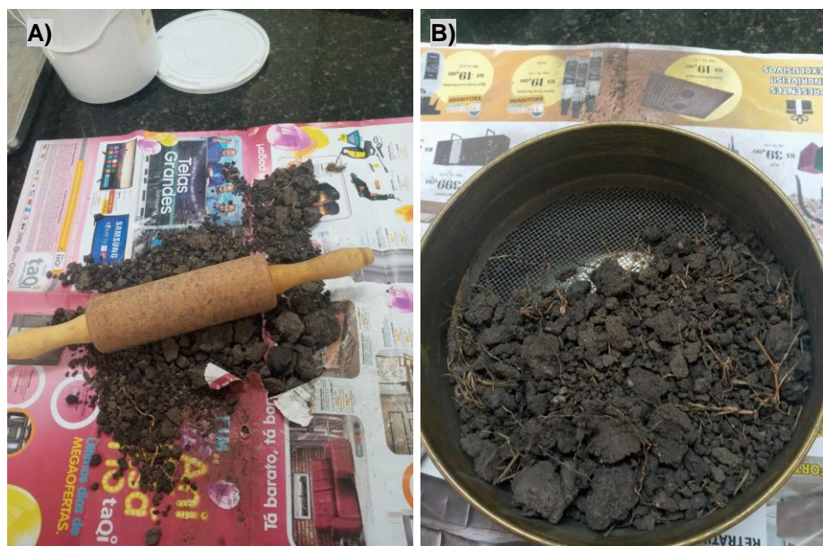
Figura 9 - Registro fotográfico de trabalho de laboratório indicando os processos utilizados no peneiramento. A Figura A indica o processo de destorroamento do solo após ser seco ao ar. A Figura B indica o processo de peneiramento.
