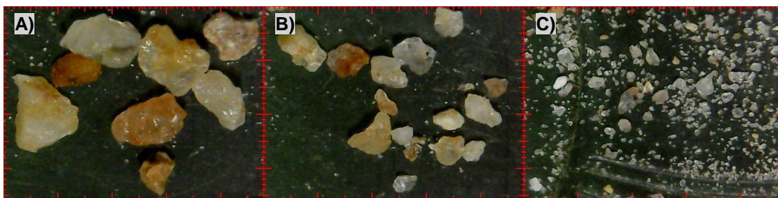
Figura 34 - Registro fotográfico evidenciando a granulometria das areias referentes ao Perfil 4 - Horizonte 2, ampliadas com o auxílio do microscópio. Figura (A) registra a granulometria areia muito grossa; a Figura (B) registra a granulometria areia grossa e a Figura (C) registra a granulometria areia média. Imagens obtidas em microscópio digital modelo U1000X. Escala de 0,2 mm.
