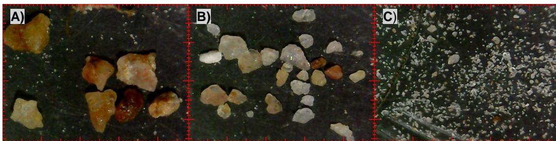
Figura 35 - Registro fotográfico evidenciando a granulometria das areias referentes ao Perfil 4 - Horizonte 3, ampliadas com o auxílio do microscópio. Figura (A) registra a granulometria areia muito grossa; a Figura (B) registra a granulometria areia grossa e a Figura (C) registra a granulometria areia média. Imagens obtidas em microscópio digital modelo U1000X. Escala de 0,2 mm.
