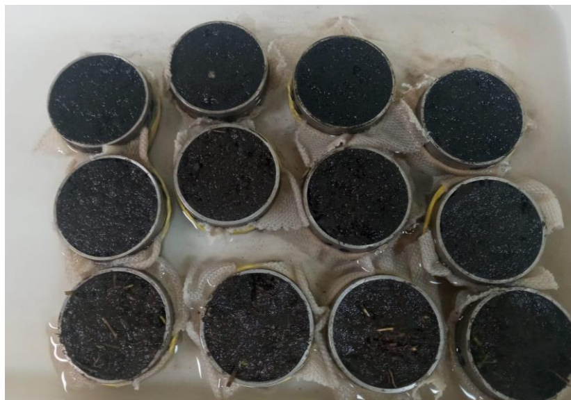
Figura 13 - Registro fotográfico evidenciando as amostras com estrutura preservada sendo saturadas por capilaridade.
