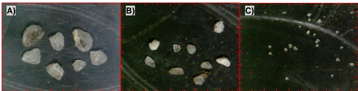
Figura 25 - Registro fotográfico evidenciando a granulometria das areias referentes ao Perfil 1 - Horizonte 1, ampliadas com o auxílio do microscópio. Figura (A) registra a granulometria areia muito grossa; a Figura (B) registra a granulometria areia grossa e a Figura (C) registra a granulometria areia média. Imagens obtidas em microscópio digital modelo U1000X. Escala de 0,2 mm. Fonte: Autora.
