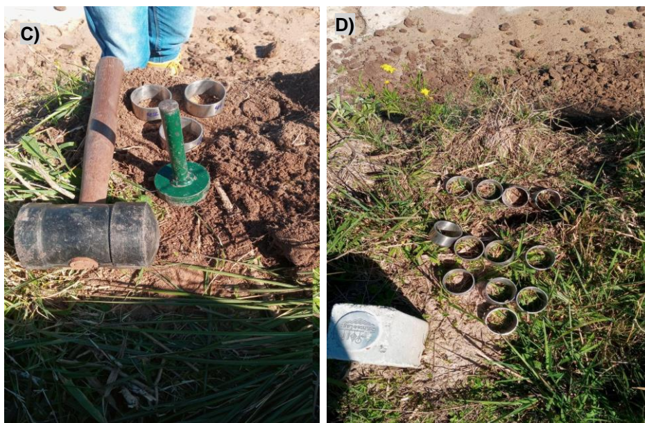
Figura 8 - Registro fotográfico de trabalho de campo. A Figura A registra a coleta de solo com estrutura preservada em cilindros de inox, referente a Trincheira 1, a Figura B registra os cilindros utilizados a campo para a coleta de solos da Trincheira 2, a Figura C registra as coletas realizadas na Trincheira 3 e a Figura D registra os cilindros utilizados na coleta do Perfil 4.
