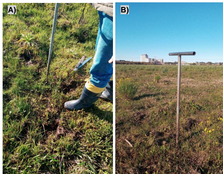
Figura 17 - Registro fotográfico de campo mostrando parte das tradagens realizadas na área de estudo. As Figuras A e B evidenciam o trado sendo cravado na área. Fonte: Autora.
