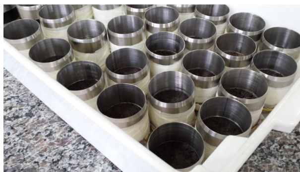
Figura 9 - Amostras preparadas e em estado de saturação por capilaridade para avaliação da condutividade hidráulica do solo saturado. Fonte: Mariana Fernandes Ramos.
