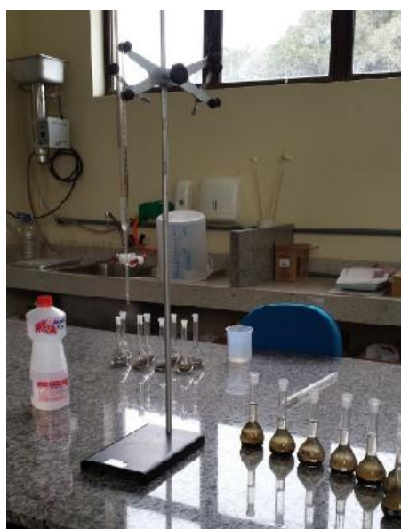
Figura 8 - Determinação da densidade de partículas. Fonte: Mariana Fernandes Ramos.
