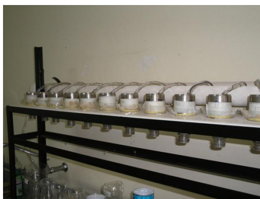
Figura 11 - Permeâmetro de carga constante para determinação em laboratório da condutividade hidráulica do solo saturado. Fonte: Luís Eduardo A.S. Suzuki.
