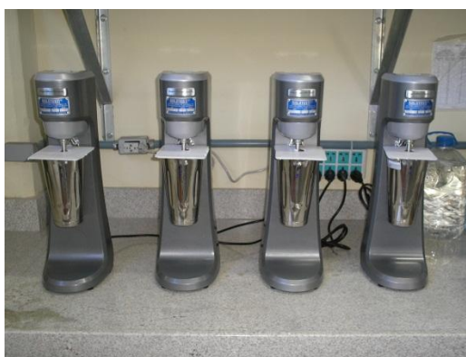
Figura 14 – Agitador elétrico tipo Stirrer utilizado na dispersão mecânica de solo e sedimento para determinação da distribuição do tamanho de partículas e argila dispersa em água. Fonte: Luis Eduardo A.S. Suzuki.
