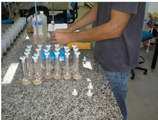
Figura 13 – Determinação da densidade de partículas utilizando o método do balão volumétrico. Fonte: Luis Eduardo A.S. Suzuki.
