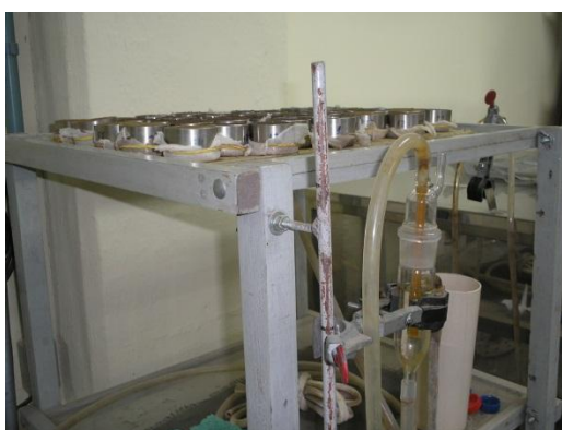
Figura 12 – Mesa de tensão com as amostras de solo com estrutura preservada. Fonte: Luis Eduardo A.S. Suzuki.
