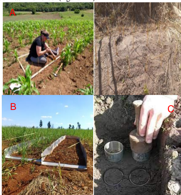
Figuras 1: Parcelas pinos de erosão (A), Parcelas isoladas (B), Amostras indeformadas (C)
