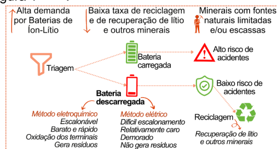
Figura 1. Esquema representativo da importância da reciclagem de baterias, com enfoque no método de descarga.
