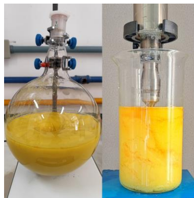
Figura 1. Síntese da curcumina no modo convencional (A1) e no método de irradiação ultrassônica (A2).
