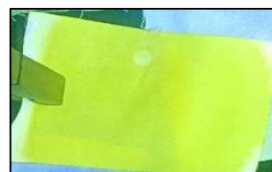
Figura 4. Amostra de tecido de nylon 240 tingido com fluoresceína usando como catalisador ZnCl 2 .
