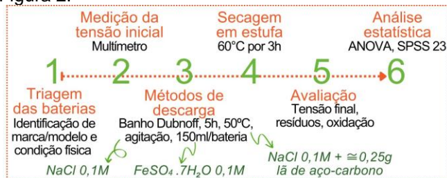
Figura 2. Fluxograma simplificado da parte experimental.
