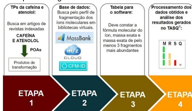
Figura 1. Fluxo de trabalho para identificação de produtos de transformação utilizando o software TASQ.
