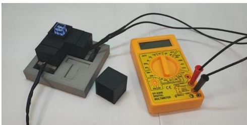
Figura 1. Imagem do equipamento impresso em filamento PLA (pintado com tinta preta para melhor isolamento luminoso).
