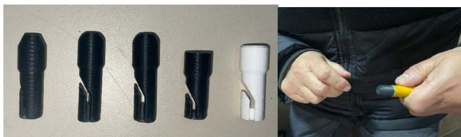
Figura 5 - à esquerda peças teste desenvolvidas e à direita aplicação da peça final na ponta da bengala para uso na escola.
