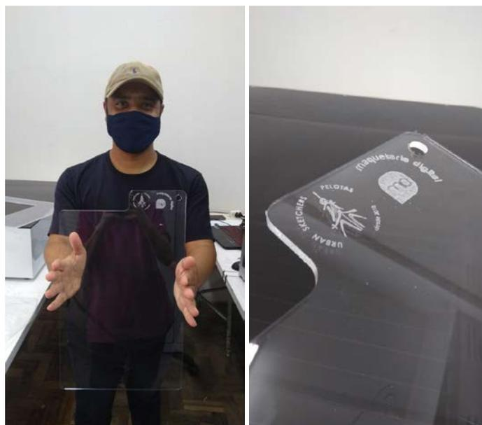
Figura 06: Pranchetas de acrílico cortadas a laser.
