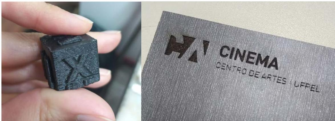
Figura 24 à esquerda - Cubo teste impresso na GTMax3D em filamento ABS. Fotografia de Marília Silveira.
