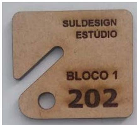
Figura 30 - Teste de corte e gravação de chaveiro para salas do Centro de Artes. Fotografia de Nadia Leschko
