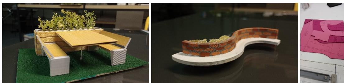
Figura 10: Impressão 3D e corte a laser para confecção de maquetes
