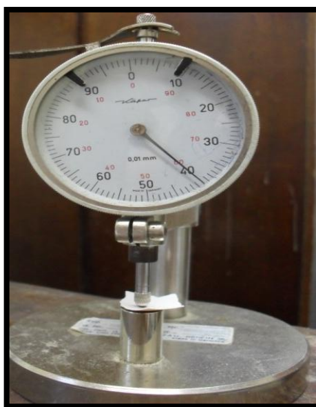
Figura 7. Micrômetro utilizado para medir a espessura da casca de ovos.
