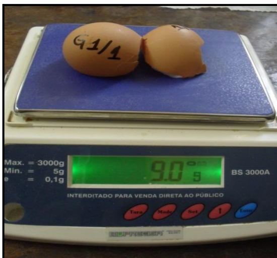
Figura 6. Balança digital utilizada para medir peso de casca.
