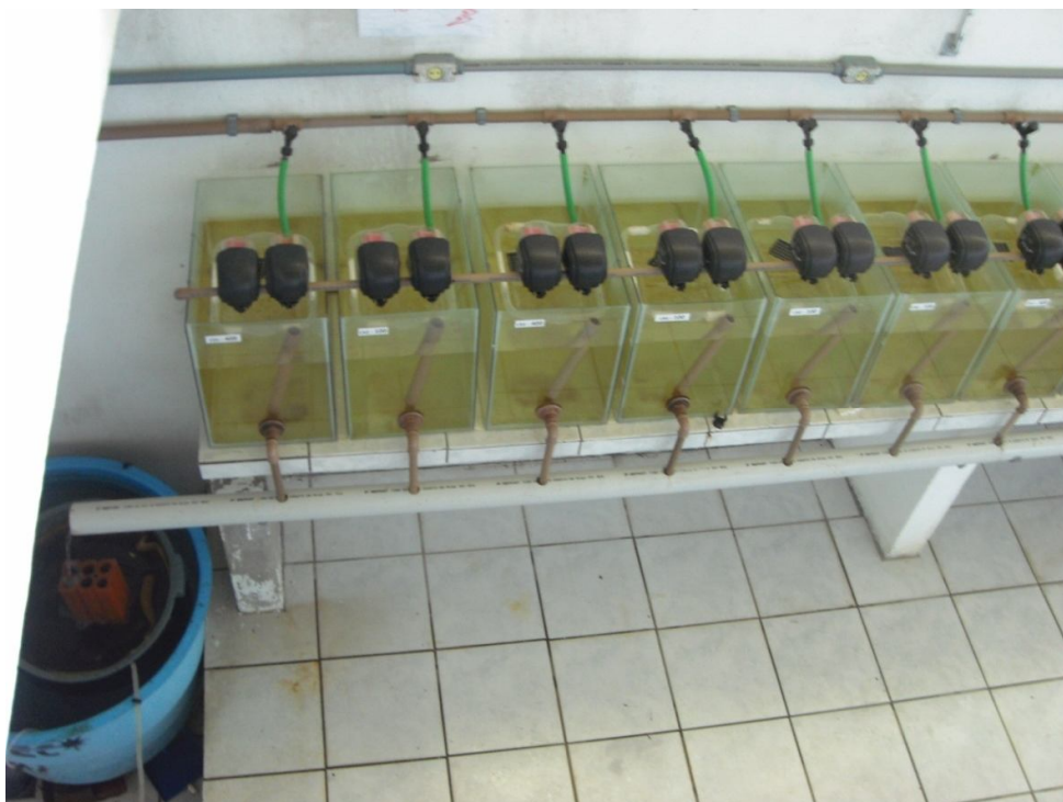
Figura 1. Circuito de aquários em sistema de recirculação de água.
