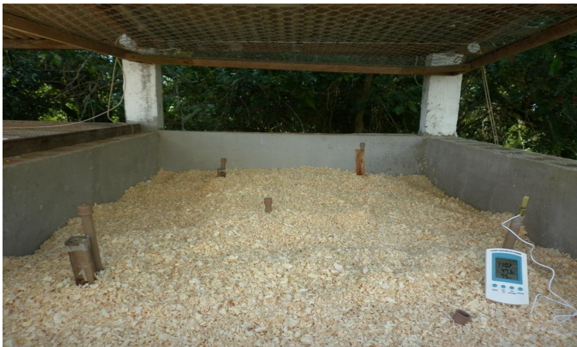
Figura 10 - Aferição da temperatura em um dos pontos na célula de compostagem. UFPel, Pelotas, RS, 2011.
