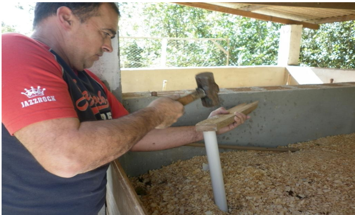
Figura 9 - Coleta de amostras com tubo de PVC de 50 mm de diâmetro. UFPel, Pelotas, RS, 2011.
