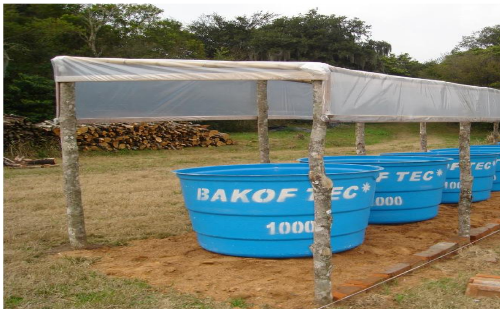
Figura 1 – Estrutura utilizada na compostagem pelo método aeração passiva. UFPEL, Pelotas, RS (2010). Fonte: Acervo do autor (2010).
