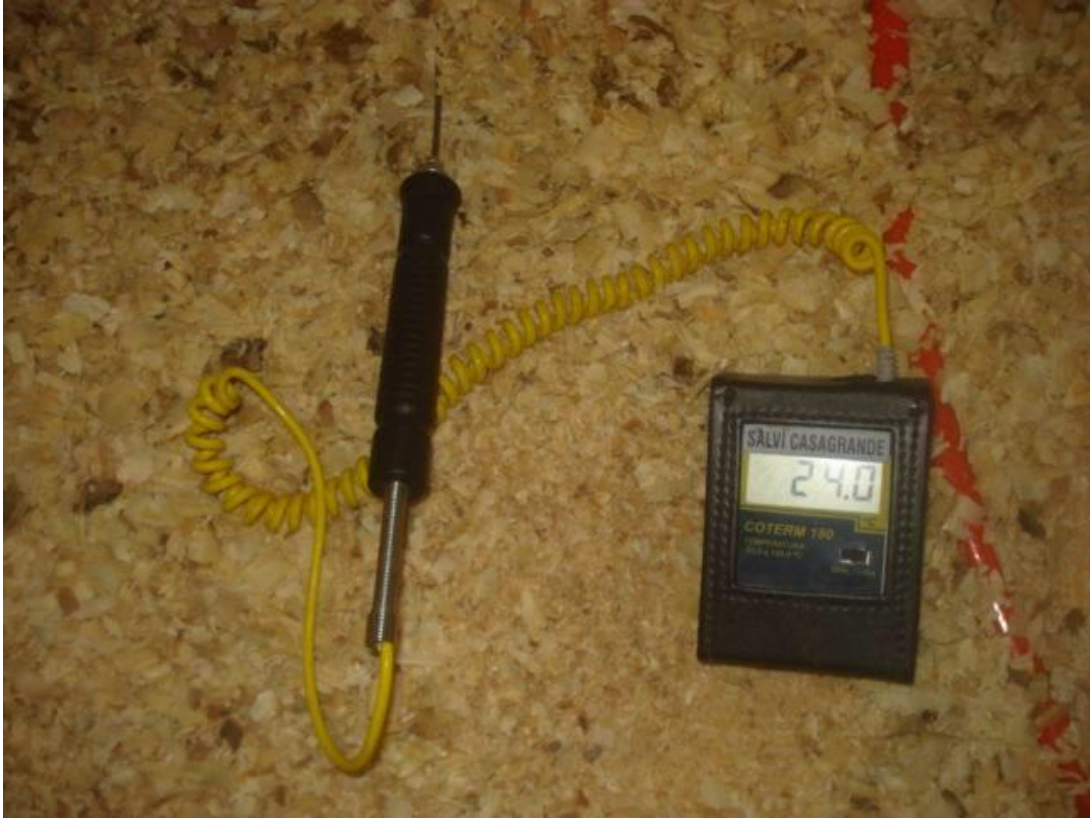
Figura 9. Medição da temperatura interna das camas aviárias
