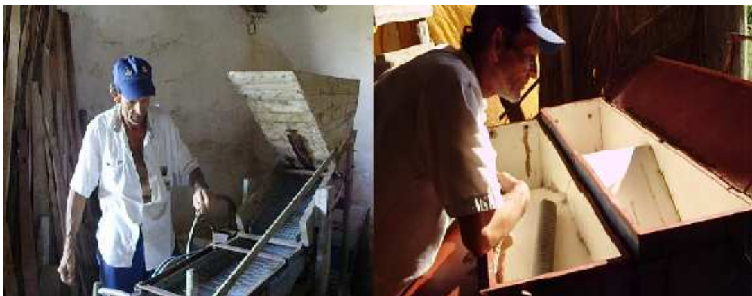
Figura 18. Maquinária artesanal fabricada por produtor de Sarandí de Barcelo para facilitar a classificação do amendoim.
