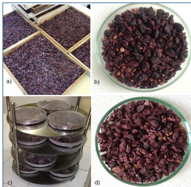
Figura 1 - Preparo das amostras de bagaço. Bagaços dispostos sobre peneiras (a) e após desidratação (b). Bagaços preparados para liofilização (c) e após liofilização (d). Fonte: acervo pessoal.
