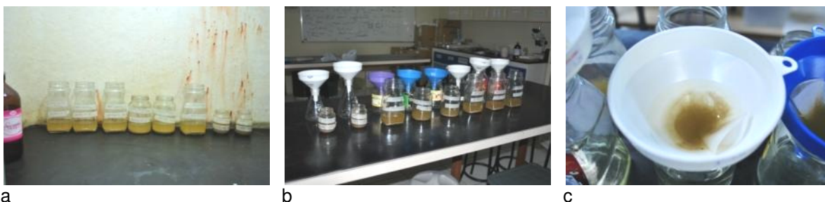
Figura 35 – (a) Amostras em digestão com solução ácida; (b) Amostras sendo preparadas para a filtragem; (c) Detalhe da filtragem, finos retidos no filtro.
