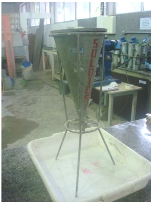
Figura 47 – (a) Funil de Marsh montado para ensaio; (b) Funil de Marsh sendo preenchido com argamassa fluida.
