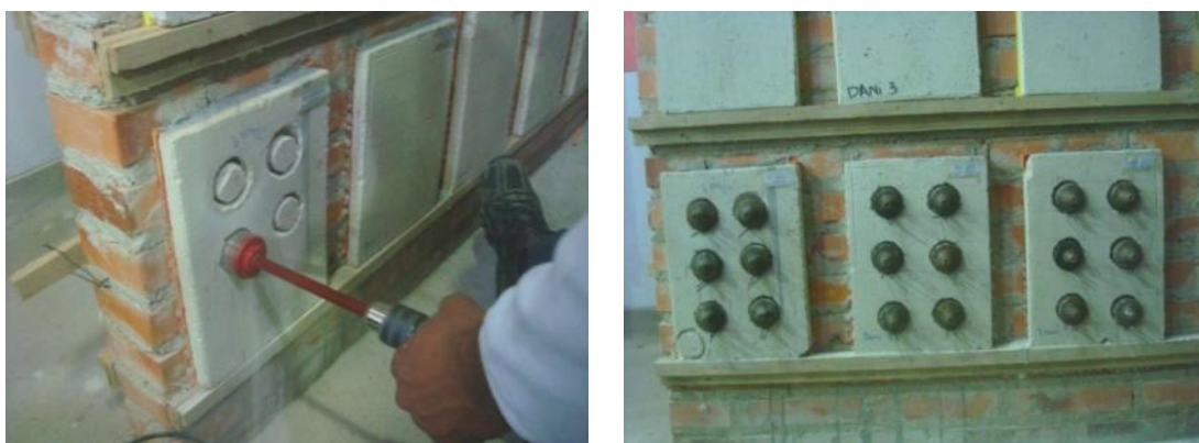
Figura 50 – (a) Corte das placas com serra - copo; (b) Colagem das pastilhas sobre os cortes nas placas.
