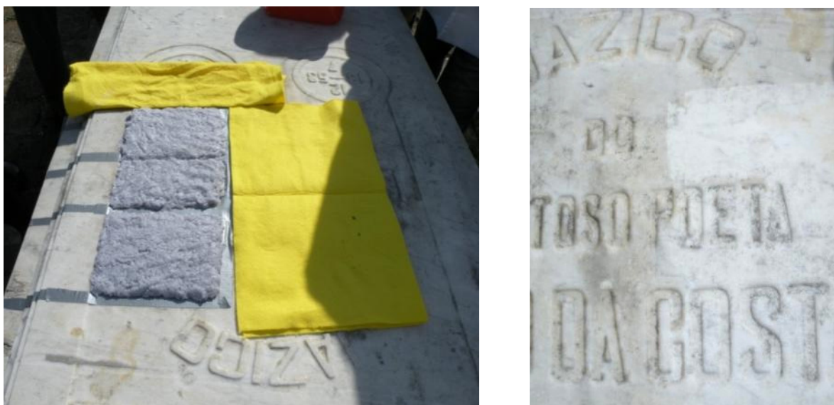
Figura 23 – (a) Teste de limpeza com emplastro de EDTA realizada sobre lápide de mármore; (b) Resultado do teste de limpeza.
