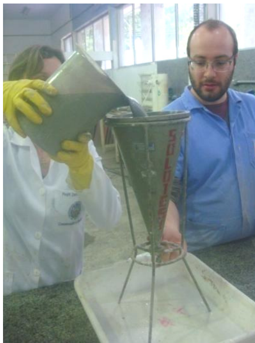
Figura 47 – (a) Funil de Marsh montado para ensaio; (b) Funil de Marsh sendo preenchido com argamassa fluida.
