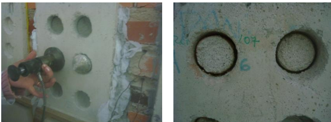
Figura 51 – (a) Ensaio sendo realizado com aderímetro fixado à pastilha; (b) Aspecto da placa que teve rotura coesiva.
