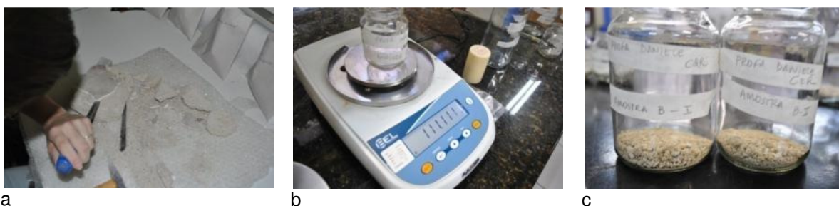
Figura 34 – (a) Separação das camadas observadas para análise individual; (b) Pesagem das porções de amostra; (c) Aspecto das amostras antes da dissolução do aglomerante.
