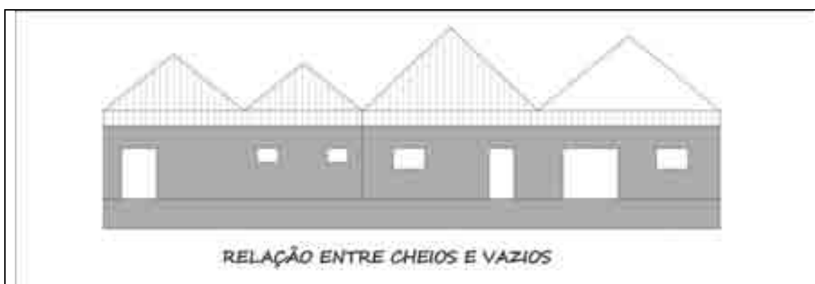
Figura 26 – Análise de relação entre cheios e vazios na fachada frontal da fábrica Indústrias Reunidas Crochemore.
