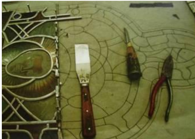
Figura 59: Processo de montagem do painel. Fonte: Morris (1987, p. 22)
