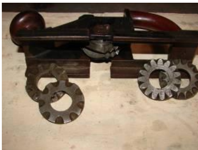
Figura 58: Exemplo de uma perfiladeira manual (espólio ateliê Casa Genta, Porto Alegre-RS).
