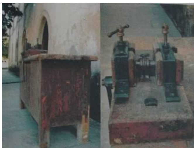
Figura 56: Exemplo de fieira manual existente no Centro de Conservação e Restauro do Mosteiro da Batalha, Portugal.
