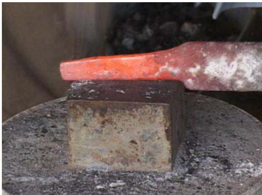
Figura 12: “Ponto certo” para malhar o metal.
