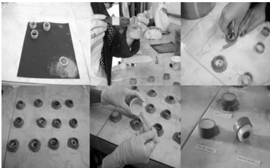
Figura 238: Sequência do processo de embutimento das amostras.
