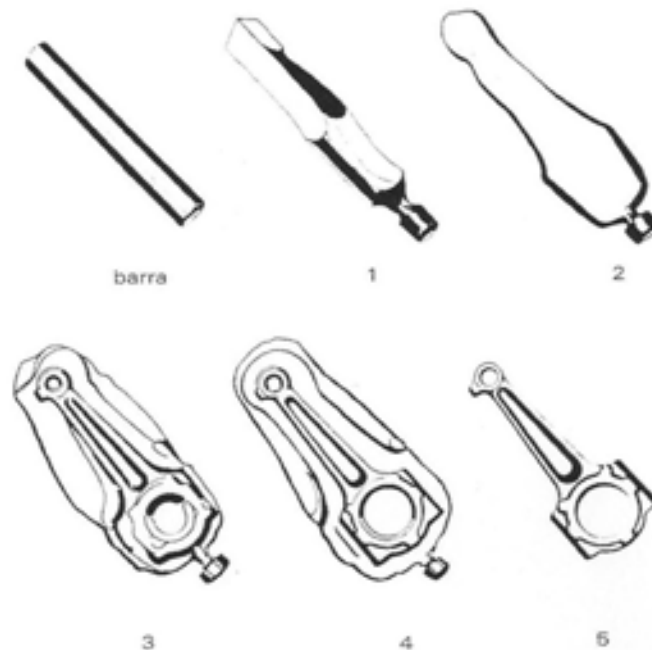
Figura 11: Etapas de conformação de uma ferramenta em forjamento feito através de matriz fechada.
