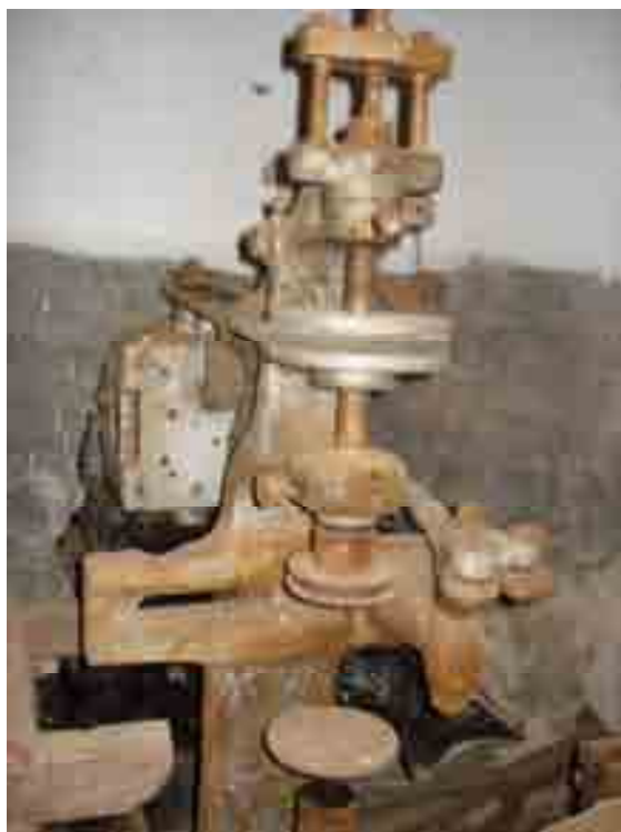
Figura 20 – Recravadeira semi-automática utilizada na fábrica de Antonio Pegoraro, na década de 1960. Localidade de Colônia Santa Helena. 2008 Fonte: Foto autor
