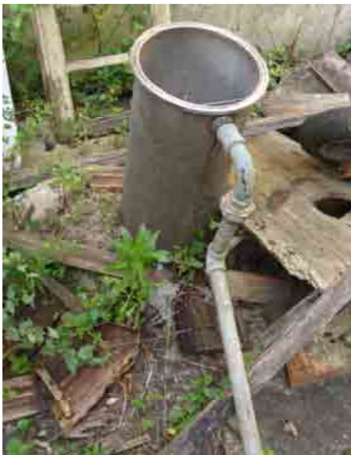
Figura 19 – Chopeira (equipamento utilizado para colocar a calda quente dentro da lata de compota). 2008 Fonte: Foto autor
