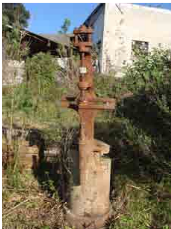
Figura 21 – Recravadeira manual utilizada na fábrica de Albino Schaun, na década de 1950. Localidade de Cascata, 2008. Fonte: Foto autor
