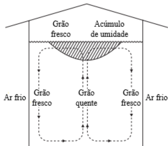
Figura 7: Correntes de ar de convecção com grãos quentes na caixa com ar mais frio ao redor
