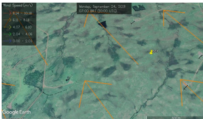
Figura 10: Resolução da simulação do comportamento de direção e velocidade do vento pelo modelo WRF.
