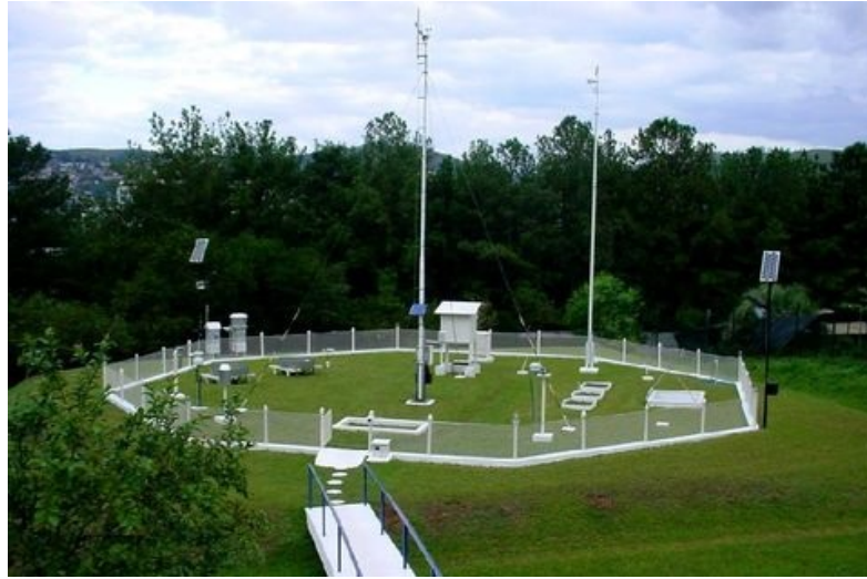
Figura 12: Modelo de estação de meteorológica de superfície do INMET Fonte: http://www.inmet.gov.br/portal/ . Acesso em: 28 Ago. 2019.
