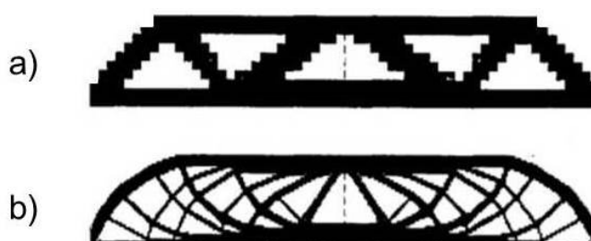
Figura 20: a) Malha discretizada em 600 elementos. b) Malha discretizada em 5400 elementos. Fonte: Sigmund e Peterson, 1998, p. 70.
