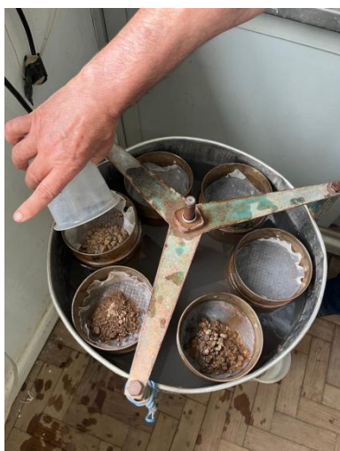
B) Imersão dos agregados em água para agitação vertical
