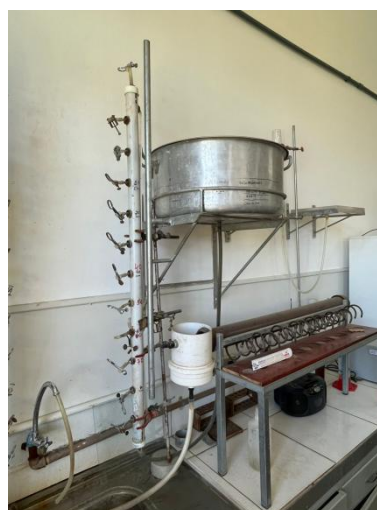
Figura 13 - Fotos de parte do processo de análises para determinação da porosidade total, macroporosidade e microporosidade das amostras de solo
