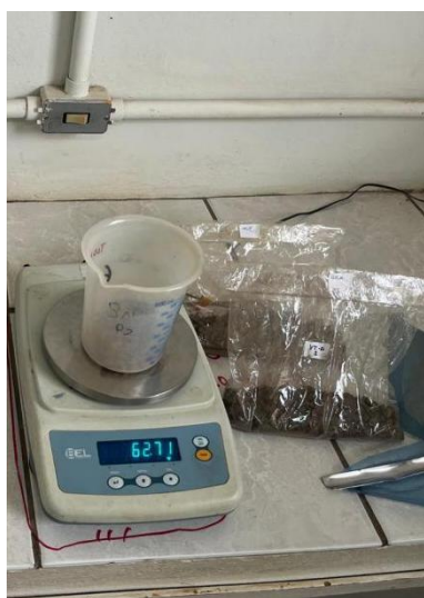
A) Pesagem das amostras deformadas de solo
