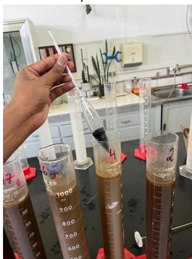
A) Preparação da amostra com uso de dispersante
