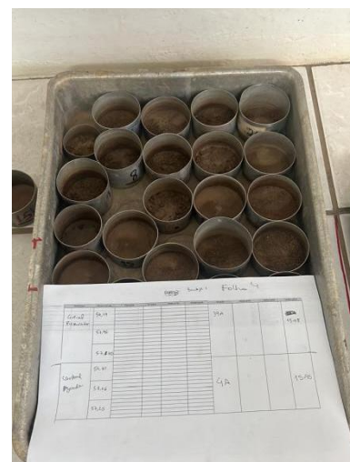
C) Secagem e pesagem de agregados estáveis
