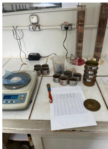
D) Classificação das frações areia em peneiras granulométricas
