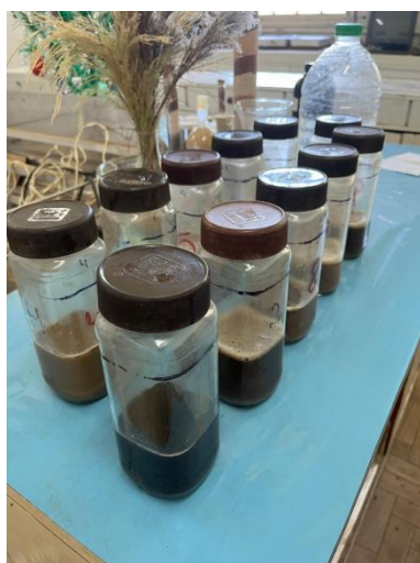
A) Preparação da amostra com uso de dispersante
