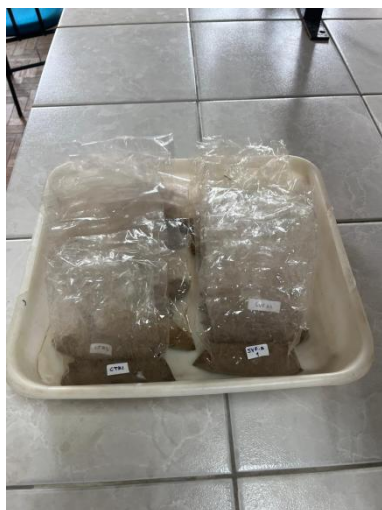
A) Amostras de solo peneiradas, secas e identificadas
