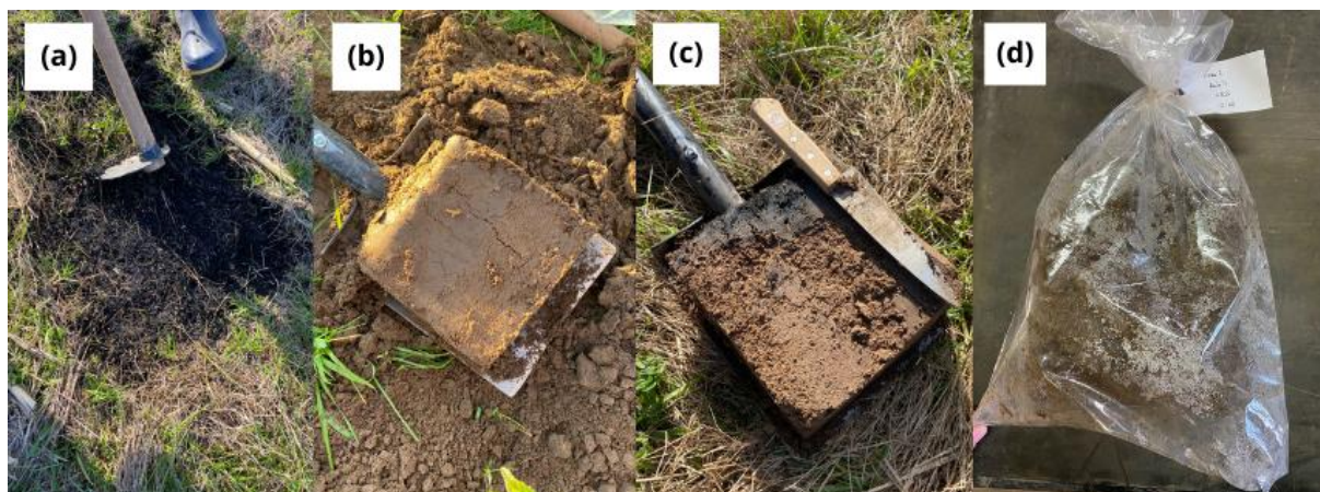
Figura 4 - Coleta de amostras deformadas nas propriedades localizadas no Passo da Micaela, interior do município de Pelotas, Rio Grande do Sul, Brasil. (a) remoção da vegetação da área superficial do solo; (b) e (c) amostra deformada de solo; (d) amostra devidamente embalada e identificada
