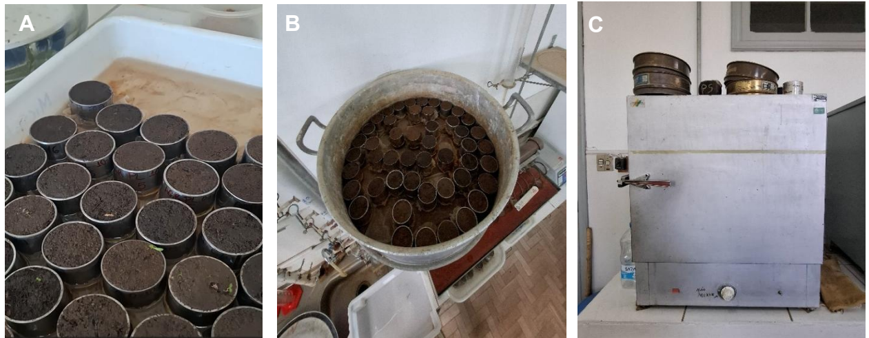
Figura 12. Amostras saturadas (A); amostras na panela (B) e amostras secas em estufa (C).
