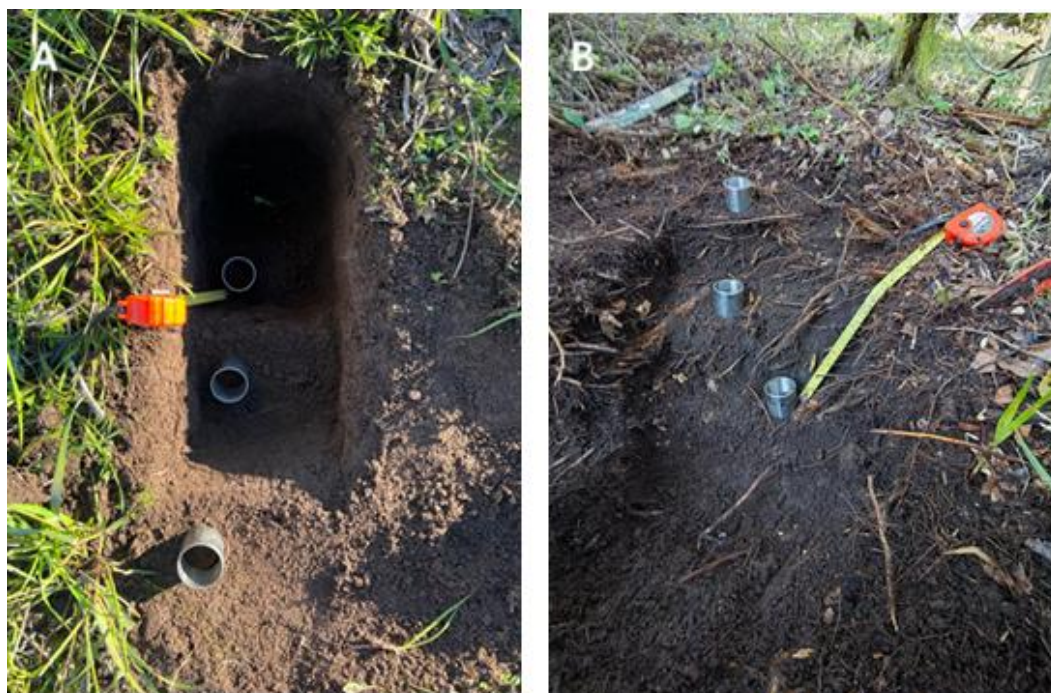
Figuras 7a 7b. Coleta de amostras indeformadas em áreas agrícolas e áreas conservadas/florestais nas camadas de 0–0,10 m, 0,10–0,20 m.
