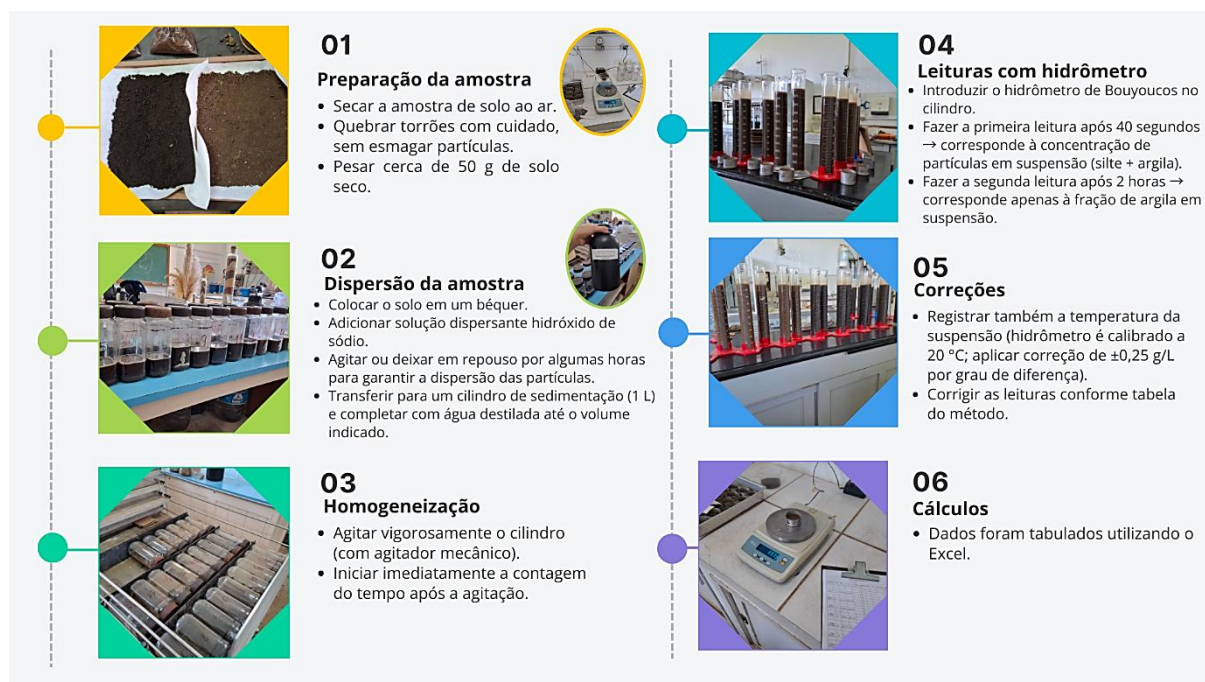
Figura 10. Procedimento metodológico: análise granulométrica pelo método do hidrômetro de Bouyoucos.
