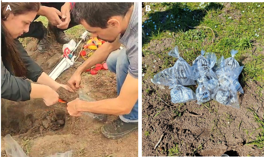
Figuras 9a e 9b. Coleta e armazenamento de amostras deformadas (A) e indeformadas (B).
