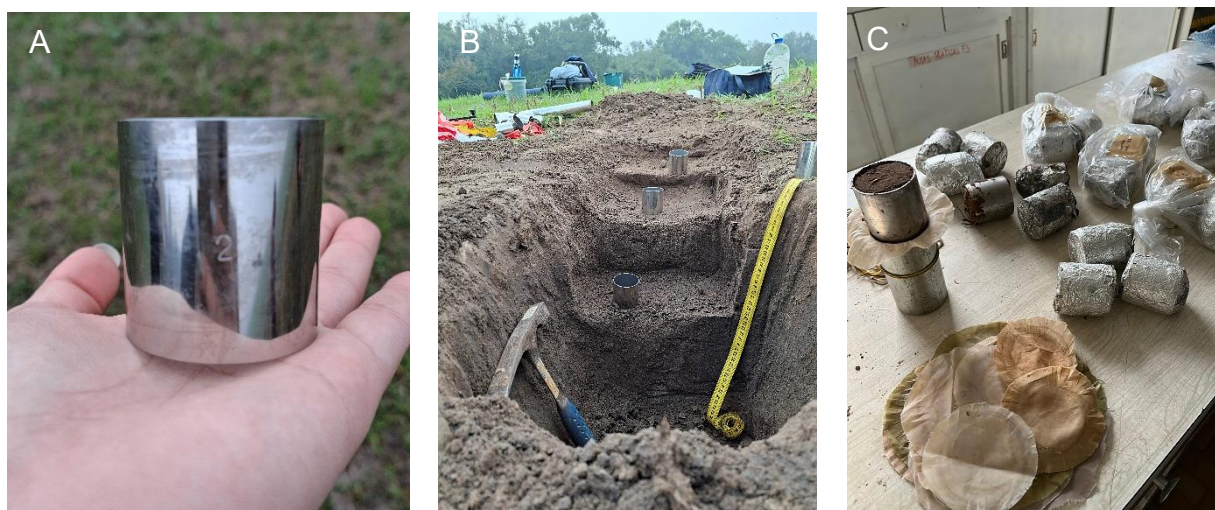
Figuras 8a 8b e 8c. Anel volumétrico de 0,05 m de altura, coletas de amostras indeformadas e tratamento em laboratório.
