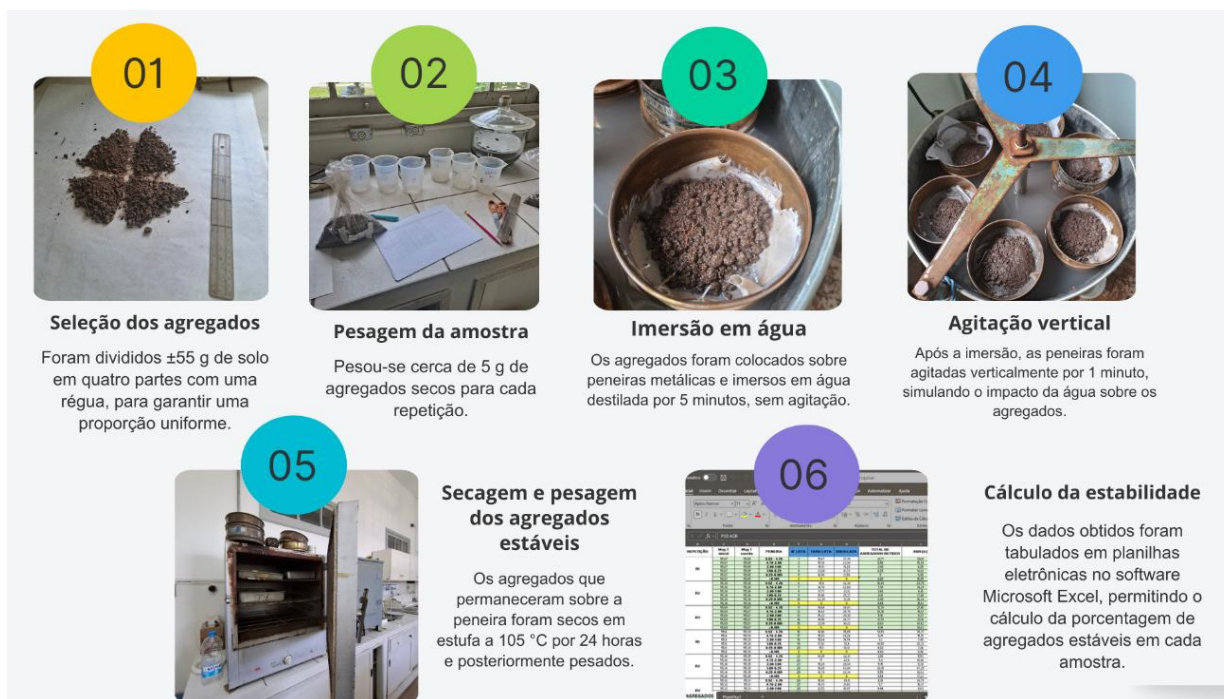
Figura 11. Etapas do Ensaio de Estabilidade de Agregados em Laboratório.
