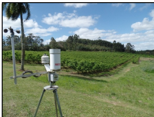
Figura 4. Estação Meteorológica Automática Squitter modelo ISIS S1220, utilizada para coleta de dados de chuva, evapotranspiração potencial, temperatura do ar, umidade relativa média do ar, radiação solar e velocidade do vento.
