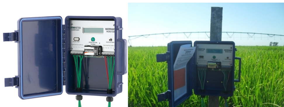
Figura 2. Datalogger instalado na área da cultura do arroz irrigado por aspersão para armazenamento contínuo dos dados de tensão de água no solo pelos sensores Watermark®.
