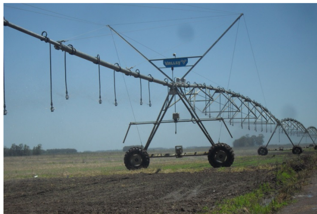
Figura 1. Sistema de irrigação por aspersão linear móvel Valley® utilizado na irrigação da cultura do arroz.
