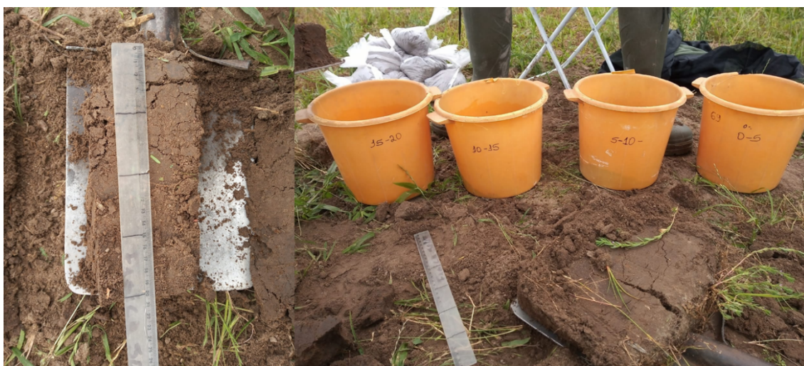
Figura 5 – Coleta de solo estratificadas em 4 profundidades, para determinação de fósforo e potássio no solo
