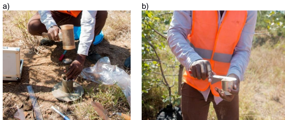
Figura 8 – Coletas amostras indeformadas utilizando anéis volumétricos.
