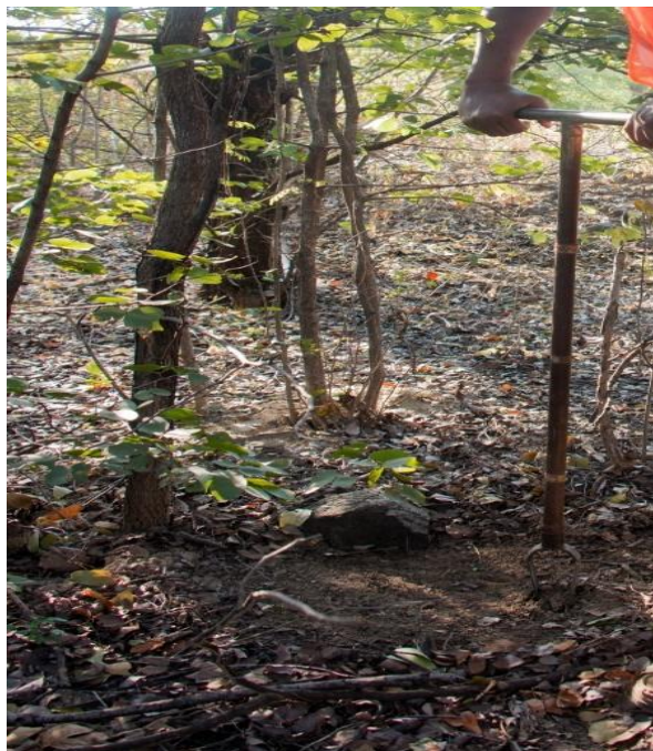
Figura 7– Coleta de amostras deformadas de solo com trado Holandês.
