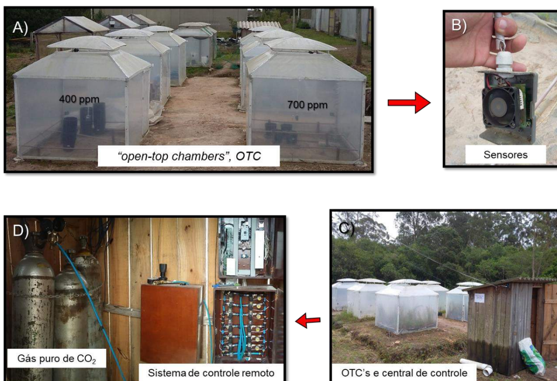
Figura 1. Área experimental com estufas de topo aberto (“open-top chambers”, OTC) (A), sensores de monitoramento da concentração da CO 2 (B) e a central de controle e armazenamento dos cilindros de CO 2 (C e D).
