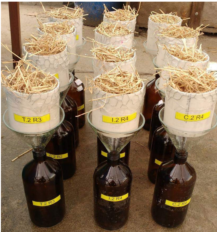
Figura 16 – Estrutura apta a receber a chuva simulada. De baixo para cima: frascos âmbar de 1L; funis de vidro com bocal de 0,12m de diâmetro; canos de PVC de 0,1m de diâmetro com telado de arame; e a palha do azevém na superfície do telado. Capão do Leão, RS, 2018.
