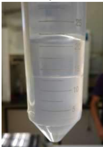
Figura 2 - Separação de fases após a adição dos sais NaCl e MgSO 4 , onde a porção superior corresponde à acetonitrila e a inferior à água destilada. Capão do Leão, 2017.
