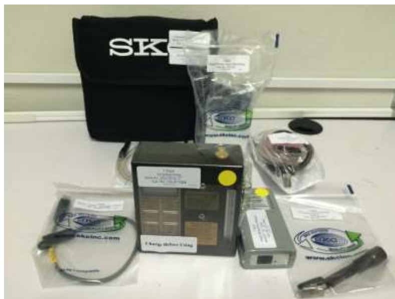
Figura 7 - Bomba de vácuo SKC utilizada na amostragem ativa do ar. Capão do Leão, 2017.
