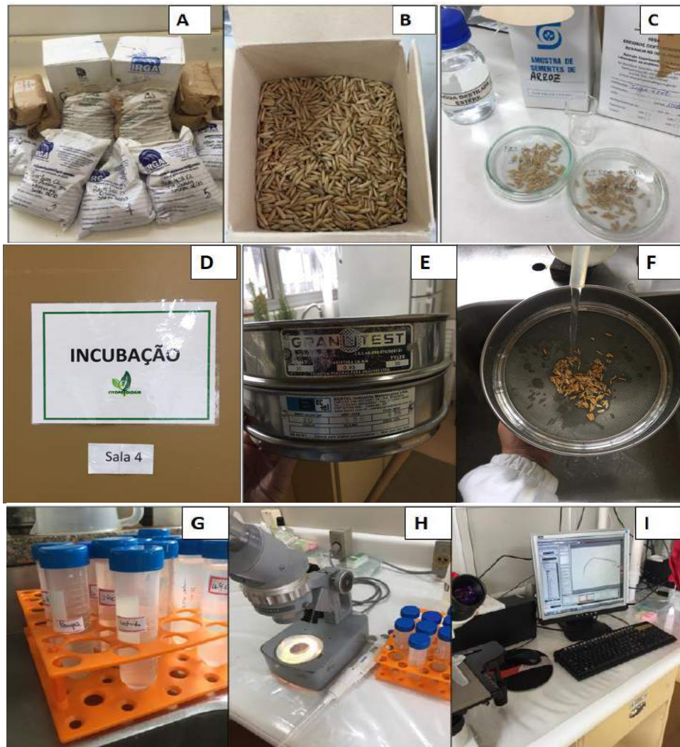
Figura 1. Extração de nematode de sementes de arroz por descascamento manual para detecção de fitonematoides. Amostras utilizadas para processamento (A e B); Placas de Petry com as sementes descascadas (C); incubação (D); Lavagem do material sobre as peneiras 20 e 635 meshes (E e F); Suspensões aquosas das amostras em tubos falcon (G); Avaliação da ocorrência e quantificação de Aphelenchoides sp. sob microscópio estereoscópio (H); Avaliações morfológicas e morfométricas dos espécimes sob microscópio utilizando-se o programa Leica Application Suite V3.7 (I).
