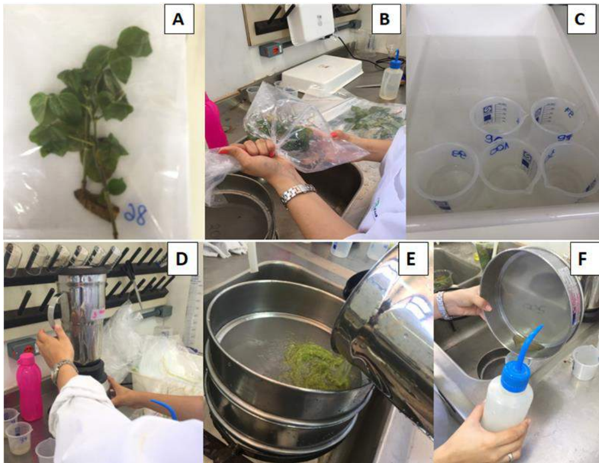
Figura 9. Lavagem e processamento das amostras: A) pré-lavagem da planta de soja; B) lavagem da planta; C) recolhimento da suspensão em Becker; D) processamento das amostras em liquidificador; E) peneiramento; e, F) recolhimento da suspensão processada em Becker para posterior avaliação do número de espécimes de A. besseyi /amostra.
