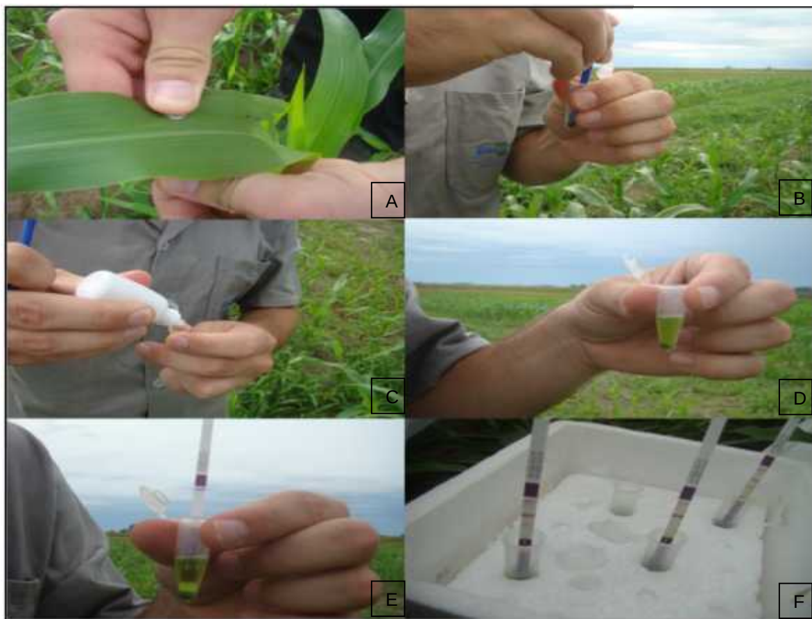
Figura 5 – Procedimentos para diagnosticar a presença ou ausência das proteínas Cry1F e Cry2A nas folhas de milho das cultivares BG7060 H e AG9045 PRO2, respectivamente. Capão do Leão, RS, 2013/14.
