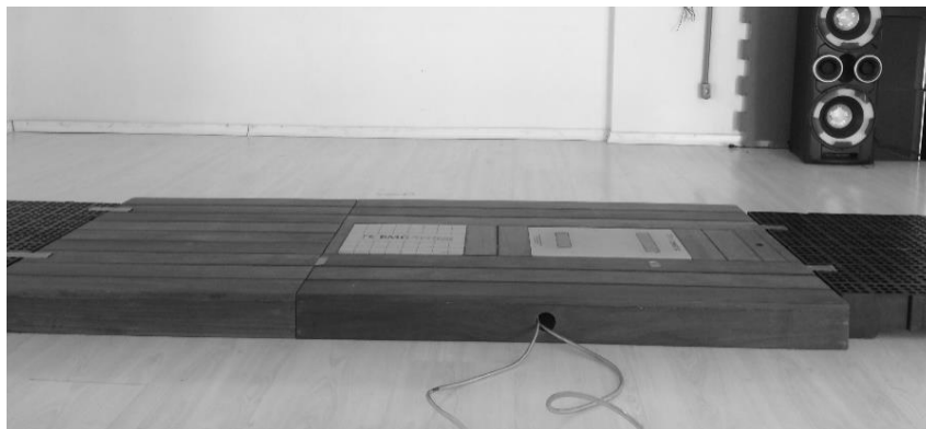
Figura 2 – Foto da passarela com as plataformas.
