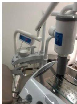
Figura 2. Equipamento de Raio X e amostra de sementes em placa de vidro. Figure 2. X-ray equipment and sample of seeds on glass plate.
