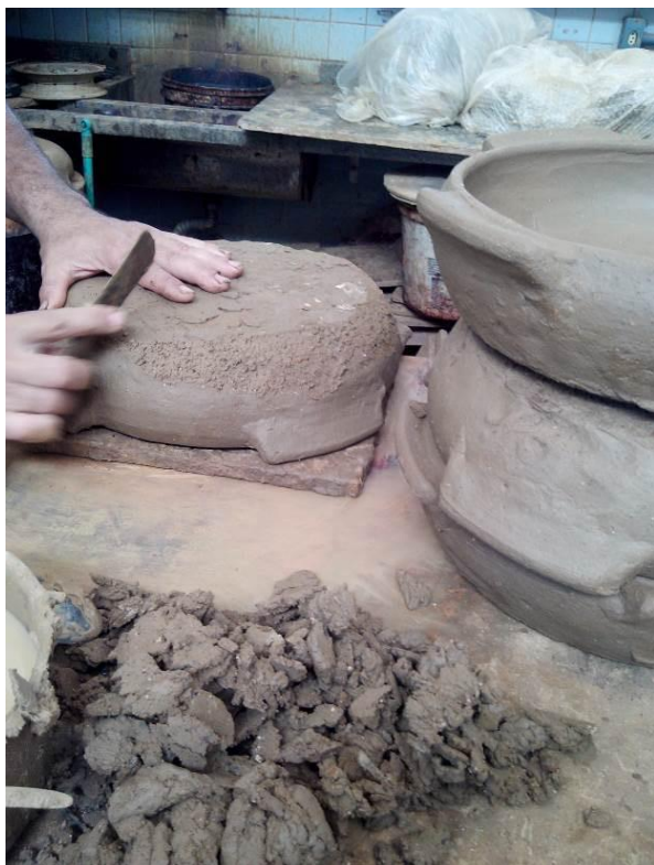
Fotos do autor: Etapa de modelagem das peças cerâmicas: à esquerda, raspagem com a faca e compressão com e à direita a pedra de rio.
