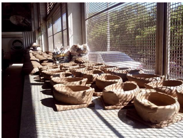
Fotos do autor: À esquerda, processo de secagem das peças cerâmicas antes da queima. À direita, área de queima e açoite do Galpão da APG.
