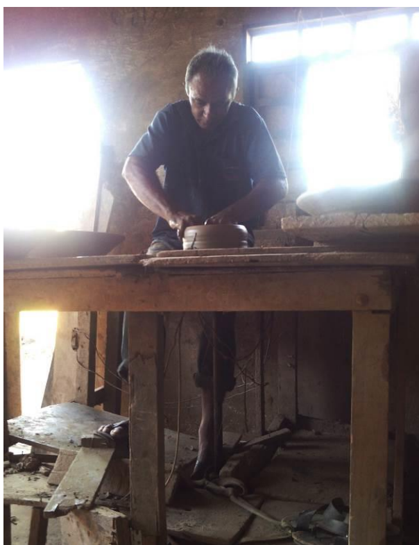
Fotos do autor: Artesão de Guarapari realizando a etapa de modelagem. Destaque para o uso do torno.
