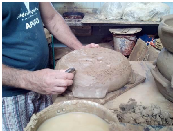
Fotos do autor: Etapa de modelagem das peças cerâmicas: à esquerda, raspagem com a faca e compressão com e à direita a pedra de rio.
