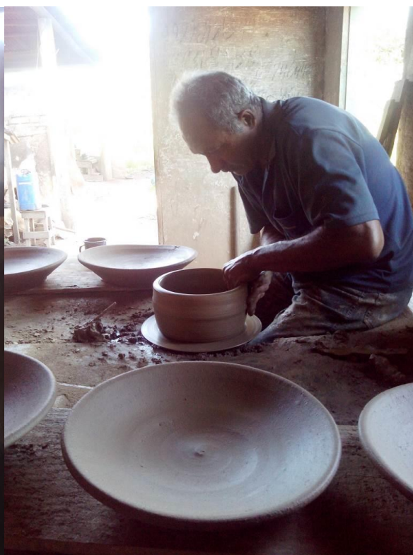
Fotos do autor: Artesão de Guarapari realizando a etapa de modelagem. Destaque para o uso do torno.
