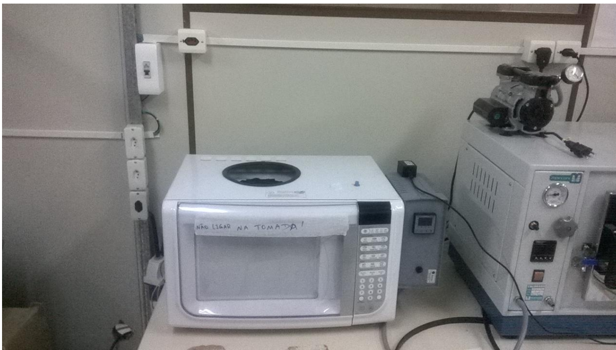
Figura 3 - Fotografia do forno micro-ondas adaptado para reator de teflon para síntese de AgNPs.
