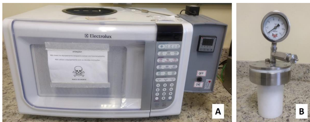
Figura 10 – Fotografias do forno de micro-ondas doméstico adaptado (A) e do reator de PTFE (B).
