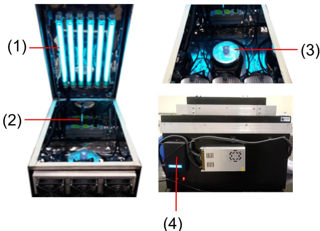
Figura 3.3 Caixa fotocatalítica com 6 lâmpadas 15 W UV-C (1), câmera acoplada (2), agitação magnética (3) e controlador de temperatura (4).
