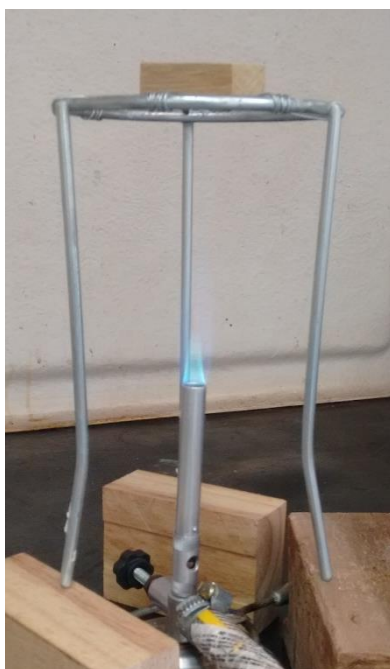
Figura 14 – Amostra de madeira submetida ao processo de combustão à curto tempo. Fonte: Autor.
