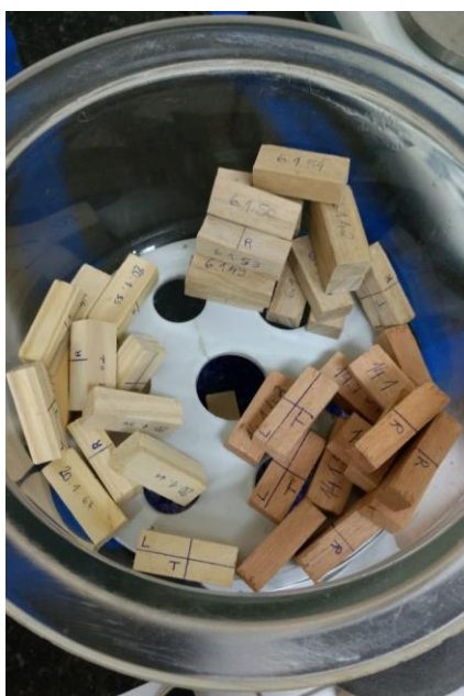
Figura 10 - Amostras prismáticas para processo de combustão a curto tempo. Fonte: o Autor.
