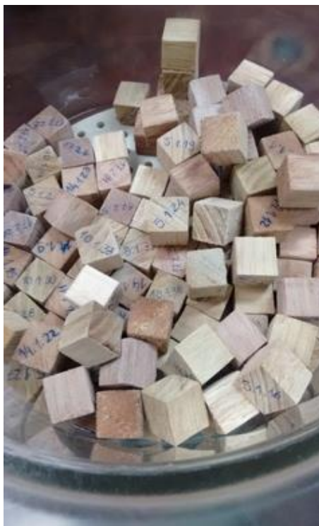
Figura 9 - Amostras cúbicas para processo de combustão a longo tempo. Fonte: o Autor.
