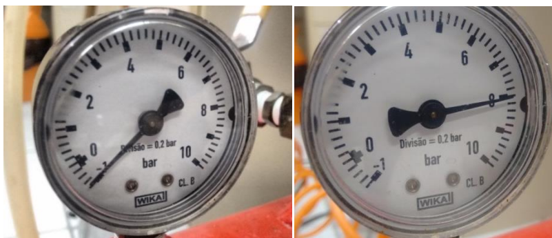
Figuras 7 e 8 – Pressões no manômetro da autoclave durante o processo Bethell de impregnação dos retardantes de chama do presente estudo. Fonte: o Autor.
