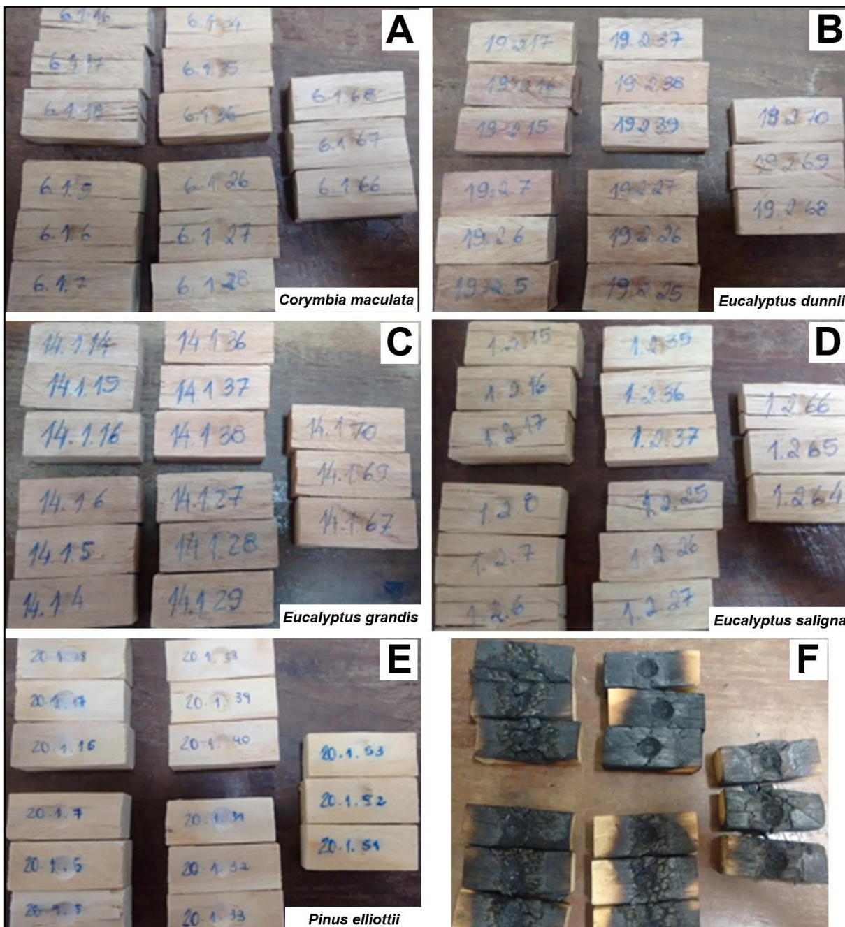
Figura 31: Amostras madeireiras após análises de Dureza Janka.
