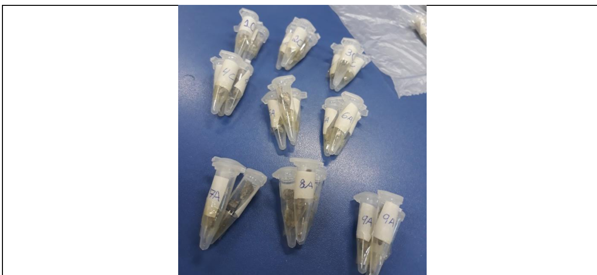
Figura 30- Amostras sólidas dos tipos de concreto para o ensaio de B.E.T
