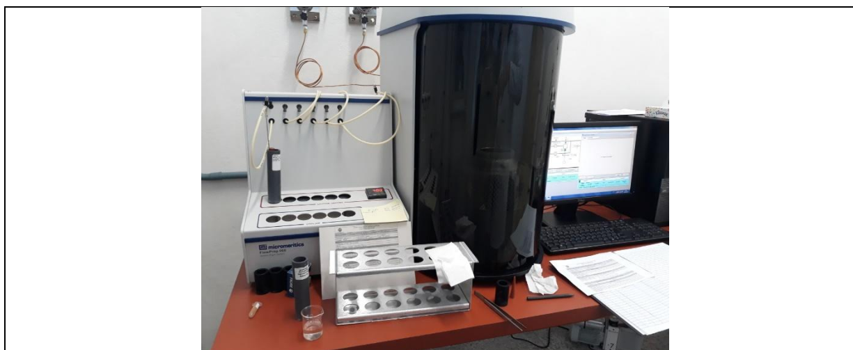
Figura 31- Equipamento Analisador de Área Superficial Gemini VII 2390A – Micromeritics
