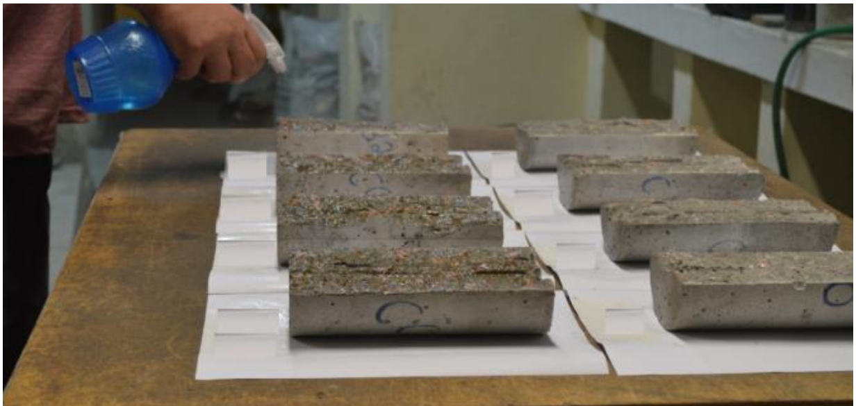
Figura 25 - Ensaio Colorimétrico – Aspersão de Nitrato de Prata.
