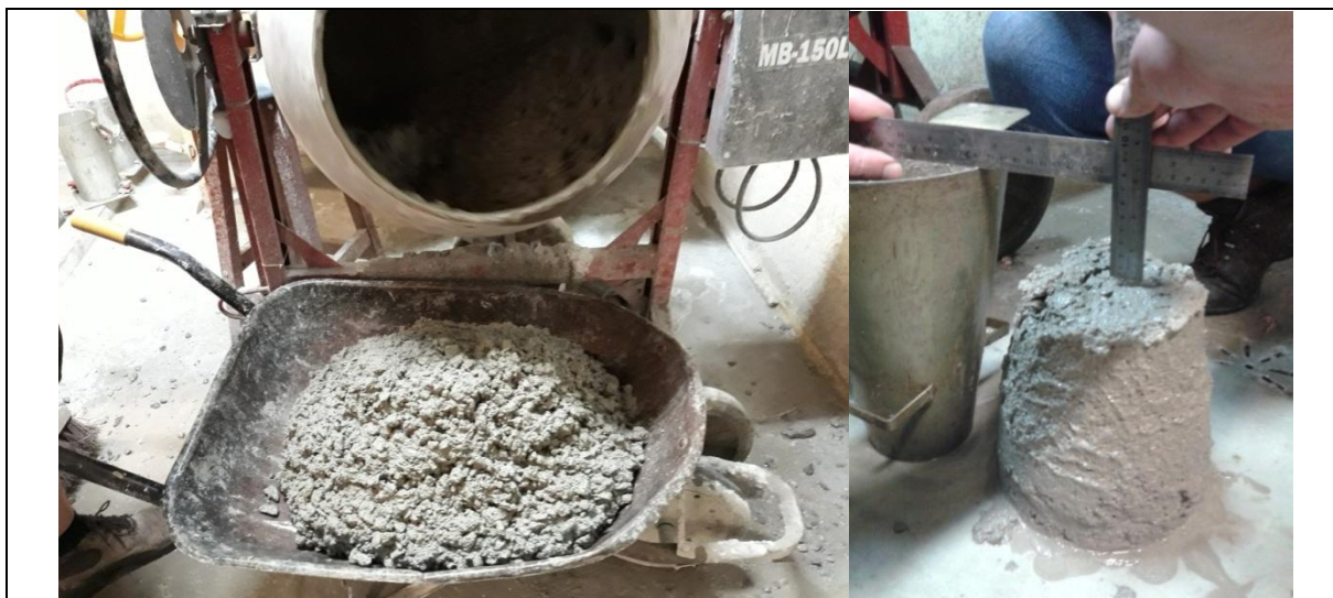
Figura 39 - Ensaio de Trabalhabilidade concreto convencional.
