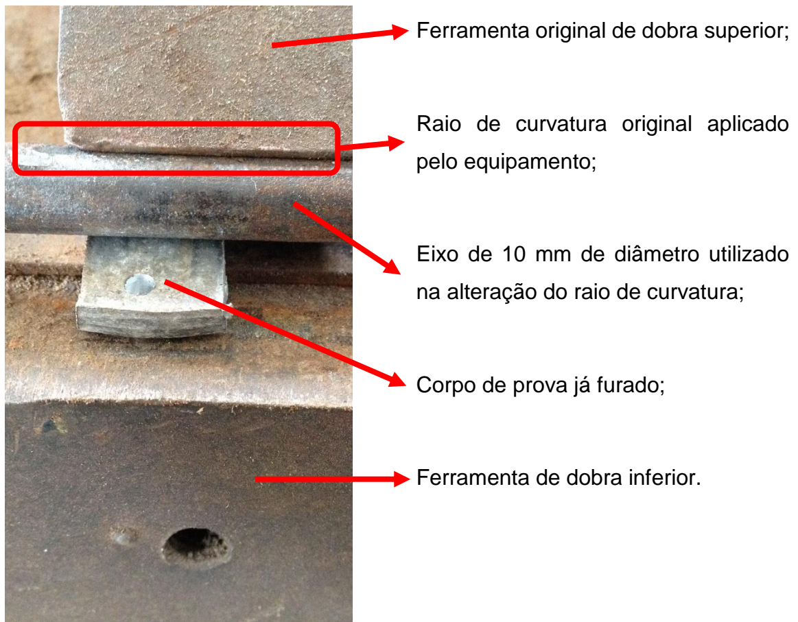
Figura 41 – Adaptação de um eixo de 10 mm de diâmetro ao estampo de dobra da dobradeira viradeira.
