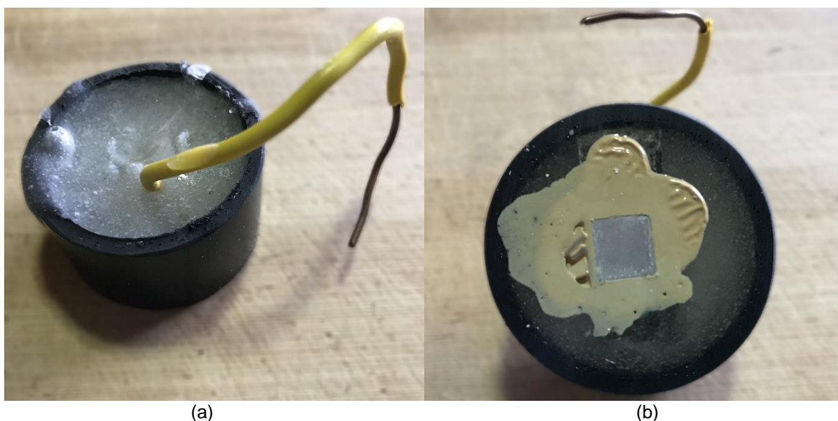
Figura 39 – Corpo de prova utilizado na caracterização eletroquímica mostrando (a) o detalhe do condutor e o (b) detalhe da área exposta.
