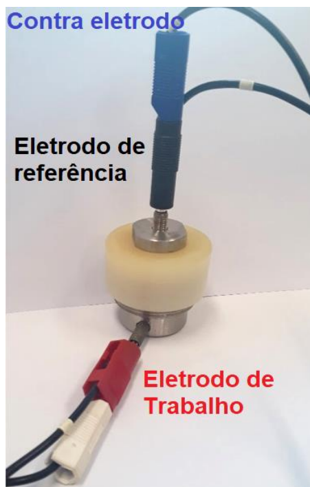
Figura 25 - Fotografia do dispositivo supercapacitor montado para análise de voltametria cíclica Fonte: Autor
