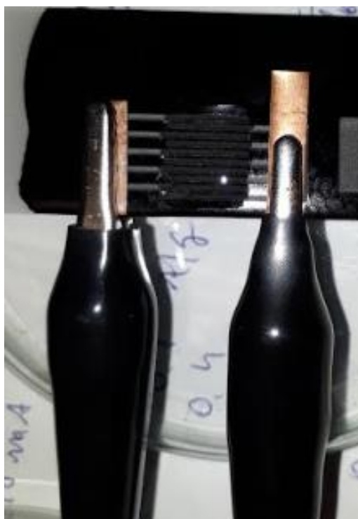
Figura A5 – Fotografia de um Microsupercapacitor de LIG, com eletrólito em gel de PVA/H 2 PO 4 e coletores de corrente de cobre. Fonte: Autor
