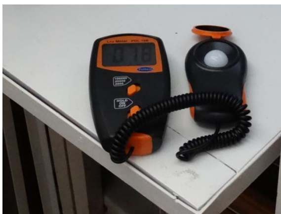
Figura 63 – Luxímetro usado no MPR, aparelho destinado a medir o nível de iluminamento ou iluminância de uma superfície. Foto: Taciane Souza, 2015.
