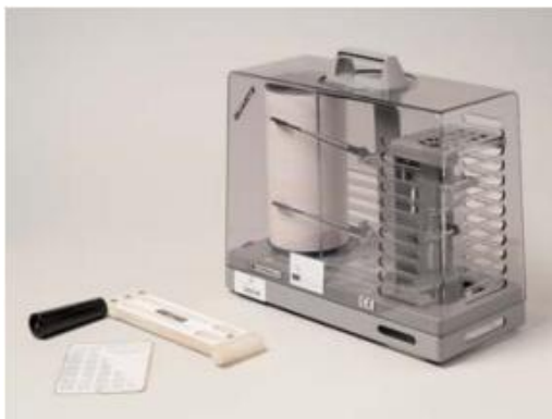
Figura 60 – Termohigrógrafo equipamento da direita, utilizado para medição e registro contínuo da umidade relativa e da temperatura. Fonte: Plano de Conservação Preventiva: Bases orientadoras, normas e procedimentos, 2007.
