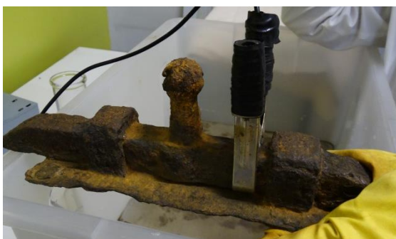
Figura 43. Artefato colonial no tratamento eletrolítico mostrando a ligação com o polo negativo da fonte elétrica.
