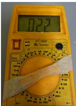
Figura 45. Multímetro empregado para o monitoramento da intensidade de corrente no sistema eletrolítico.
