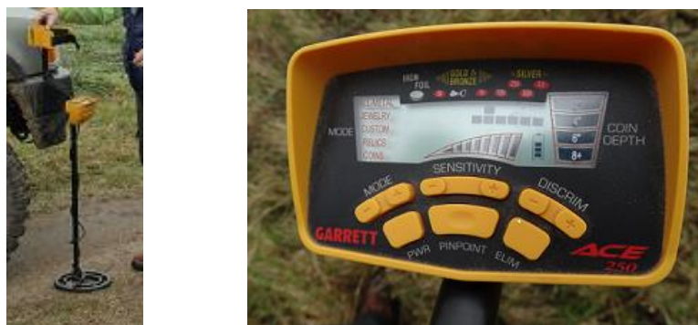
Figuras 6 e 7. Detector de metal Marca Garrett modelo 250 e detalhe ampliado do visor, onde aparecem os indicadores de profundidade, sensibilidade e tipo de metal. Fonte: Susana dos Santos Dode
