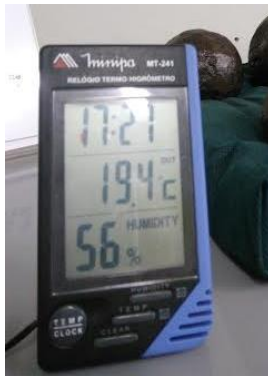
Figura 57. Termohigrômetro empregado no LÂMINA para o controle da temperatura e da umidade relativa do laboratório de conservação. Fonte: Susana dos Santos Dode.
