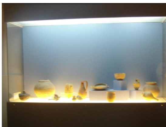
Figura 67. Vitrine com fontes de luz incandescente interna e muito próxima dos artefatos, provocando aumento significativo da temperatura.
