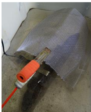
Figura 44. Detalhe do ânodo de sacrifício (rede de aço inoxidável) e da ligação com o polo positivo da fonte elétrica.
