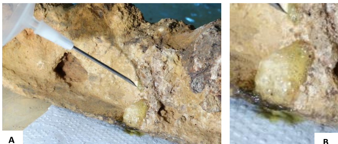
Figura 36. Realização do teste de carbonato num artefato construtivo de ferro do século XVIII (A.: aplicação de solução diluída de ácido clorídrico mediante agulha hipodérmica; B): detalhe da reação de efervescência na concreção calcária.
