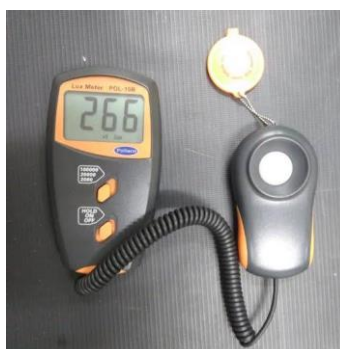
Figura 58. Luxímetro empregado no LÂMINA para a quantificação da intensidade luminosa na área dos trabalhos de conservação. Fonte: Susana dos Santos Dode
