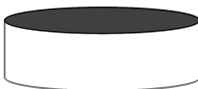
Figura 28 – Corrosão uniforme. Fonte: autora.
