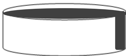
Figura 34 – Corrosão laminar. Fonte: autora.
