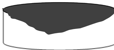
Figura 33 – Corrosão por erosão. Fonte: autora.
